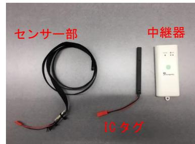
図-1 漏水検知システム (実際に設置したもの)
